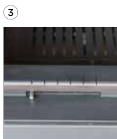
3 Registro primario. Mecanismo que aporta oxígeno a la combustión a través de la reja del fuego.
