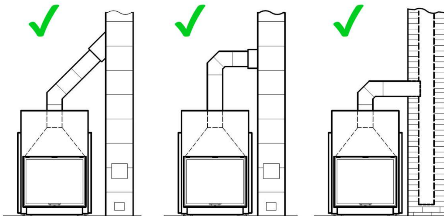
Рисунок 7. Допустимые варианты сопряжения с минеральным и стенным дымоходом.
